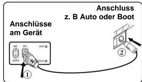
Schließen Sie das eine Ende des **DC Netzkabels** an den DC-Anschluss des Gerätes ① und das andere Ende ② an den Zigarettenanzünder (z.B. des Autos oder Bootes) an.
