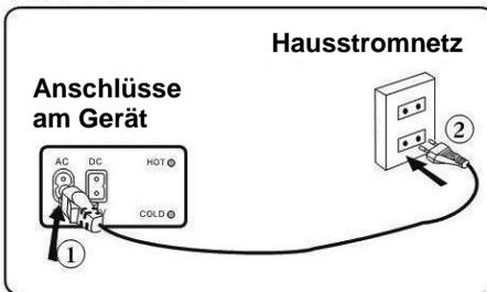
Schließen Sie das eine Ende des **AC Netzkabels** an den AC-Anschluss des Gerätes ① und das andere Ende ② an das Hausstromnetz.
