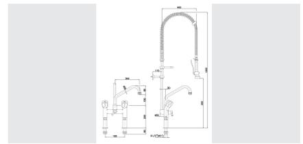
Unverzichtbar in jeder Spülküche – Dieser Zweigriffmischer erreicht eine hohe Reinigungskraft mit einer Durchflussmenge von bis zu 40 Litern pro Minute.
